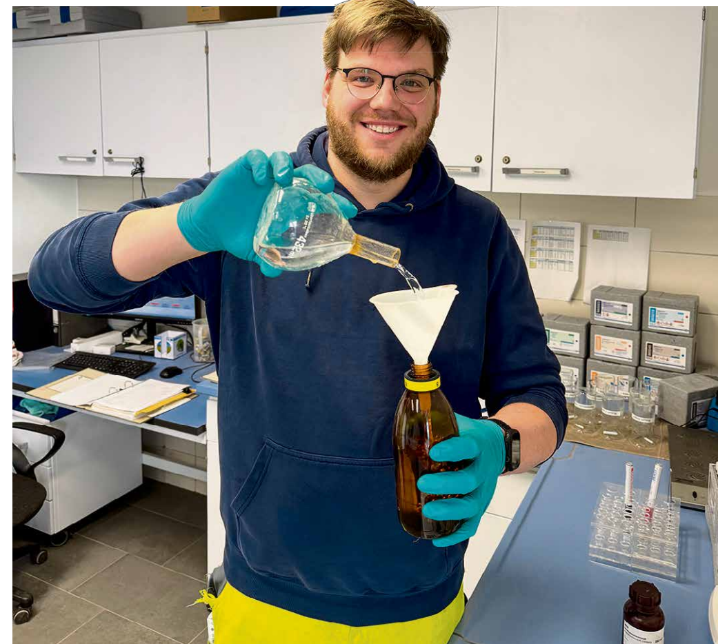
Im Analyseraum testet Meister Ken Hein den biologischen Sauerstoffbedarf des gereinigten Abwassers
